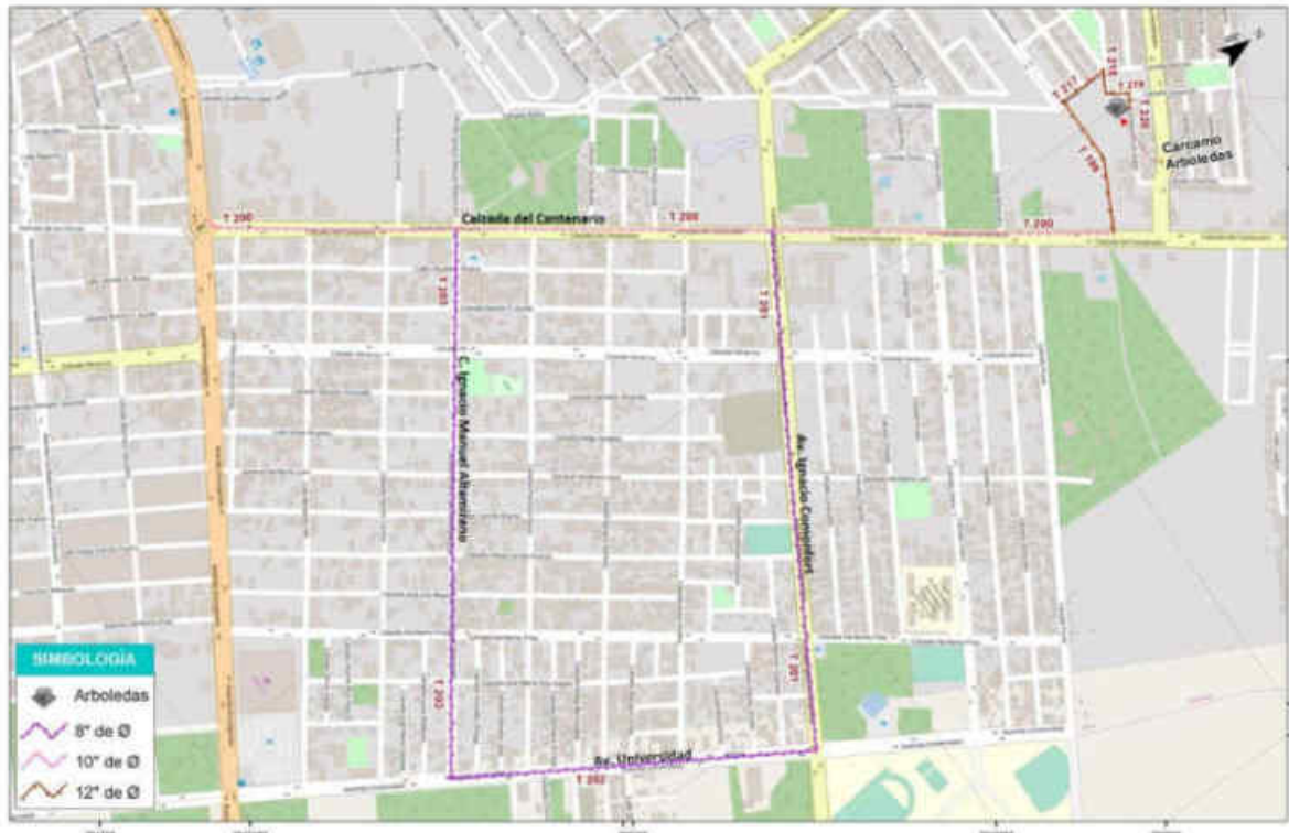
Figura IV 5 Ubicación de las líneas primarias de proyecto y del Tanque Arboledas.
