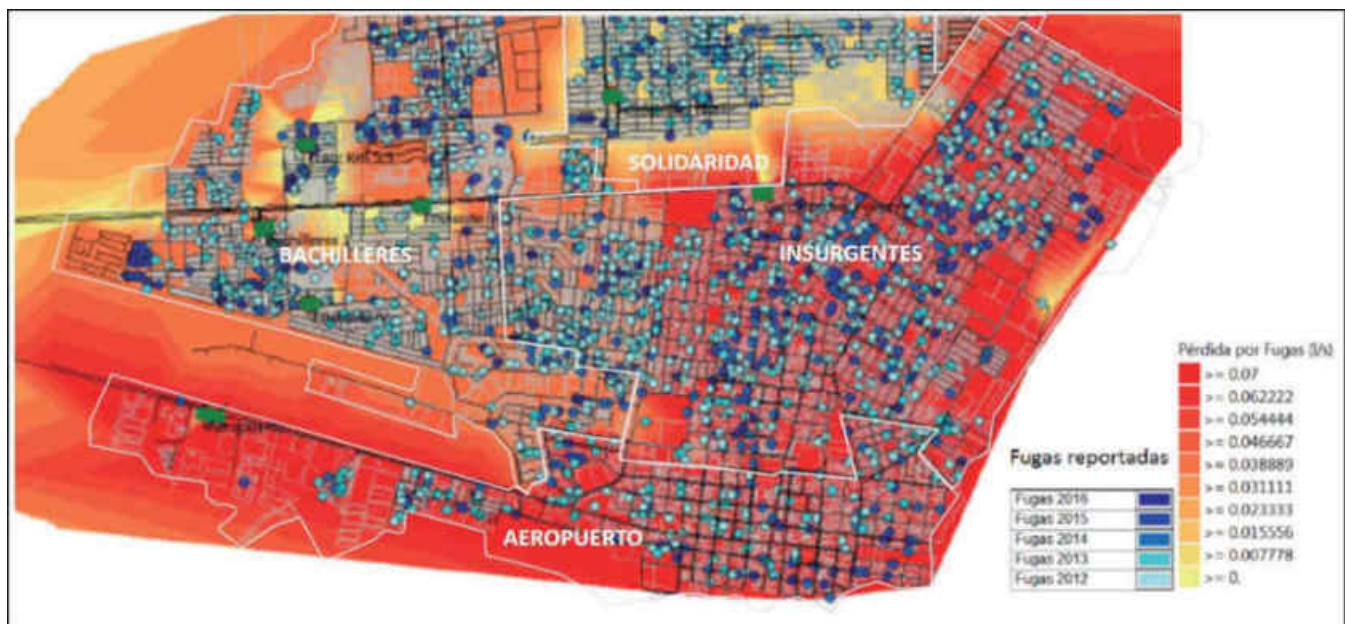
Figura II. 8 Comparación entre las pérdidas por fugas y el número de fugas reportadas por sector (2012-2016).
