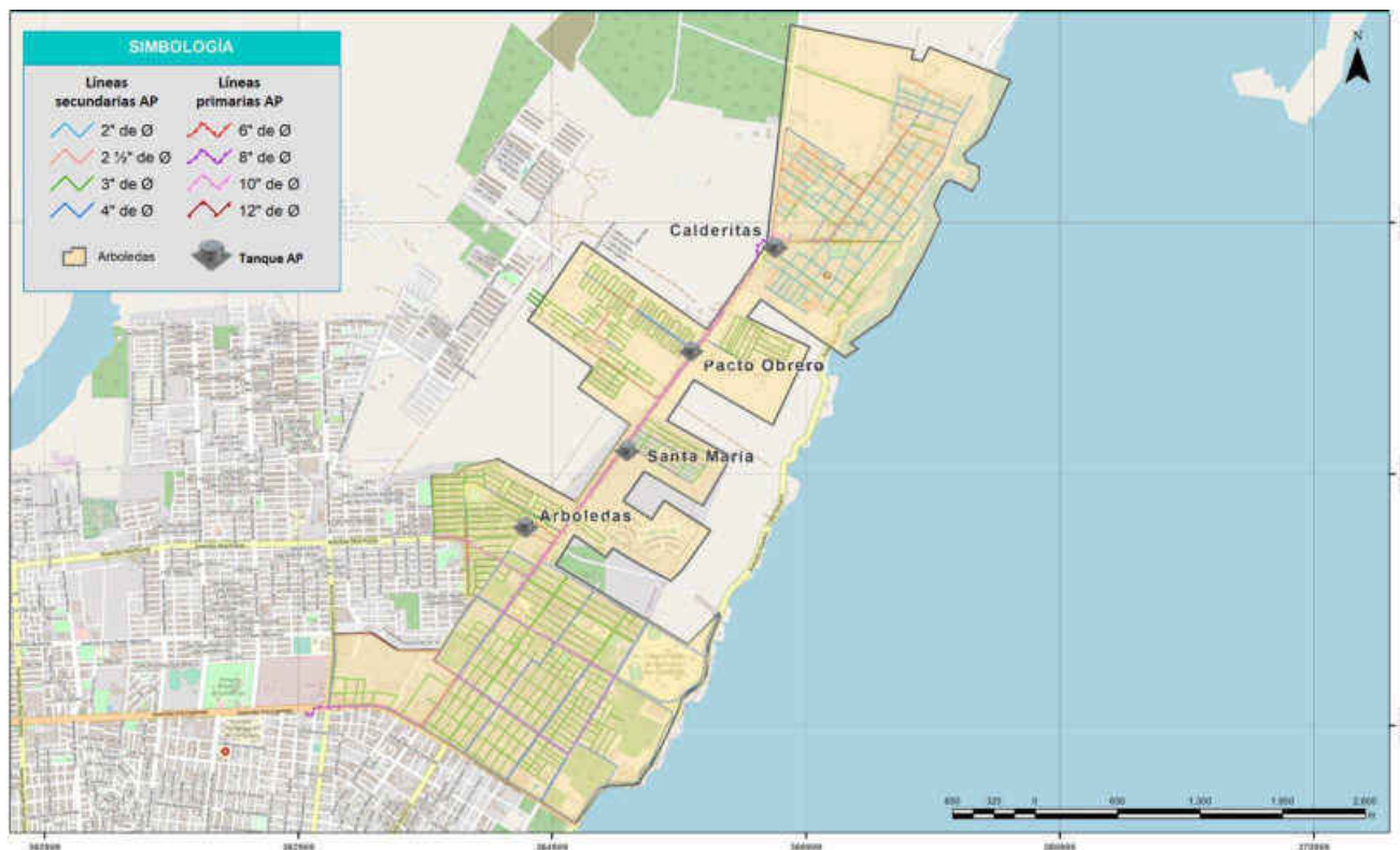
Figura II. 14 Infraestructura de almacenamiento, regulación y distribución en el MS-Arboledas del sistema Chetumal.
