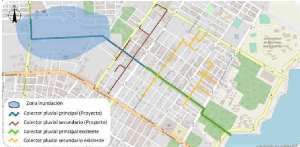
Figura III 1 Construcción de colector pluvial principal y secundarios en la zona de Soriana
