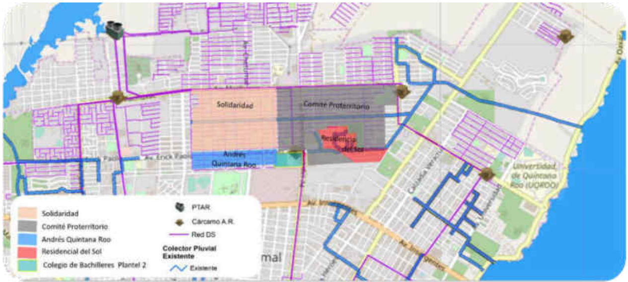
Figura II. 24 Colonias con cobertura de infraestructura de Drenaje sanitario con problemas de desbordamientos ante la presencia de lluvias.
